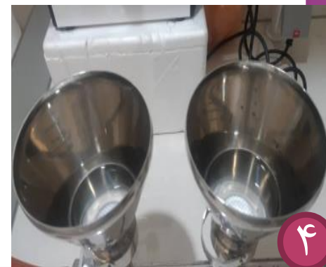
عبور نمونه ها از دستگاه فیلتراسیون
