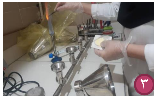
قرار دادن فیلتر در دستگاه با رعایت شرایط استریل
