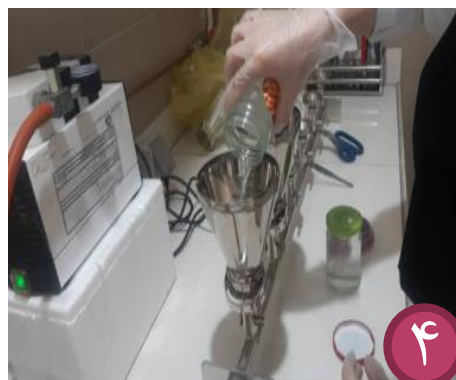
عبور نمونه ها از دستگاه فیلتراسیون
